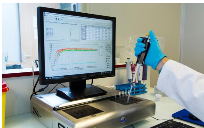
Photo 10 : Agrégomètre optique à 8 canaux (Hôpital Universitaire International Cheikh Zaid)
