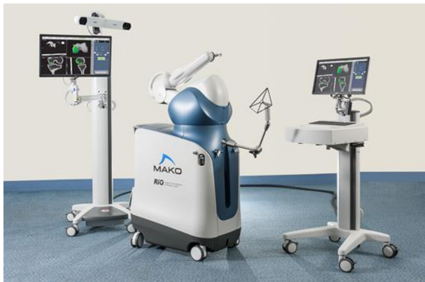
Figure 75: Le robot le plus couramment utilisé pour arthroplastie de la hanche et du genou
