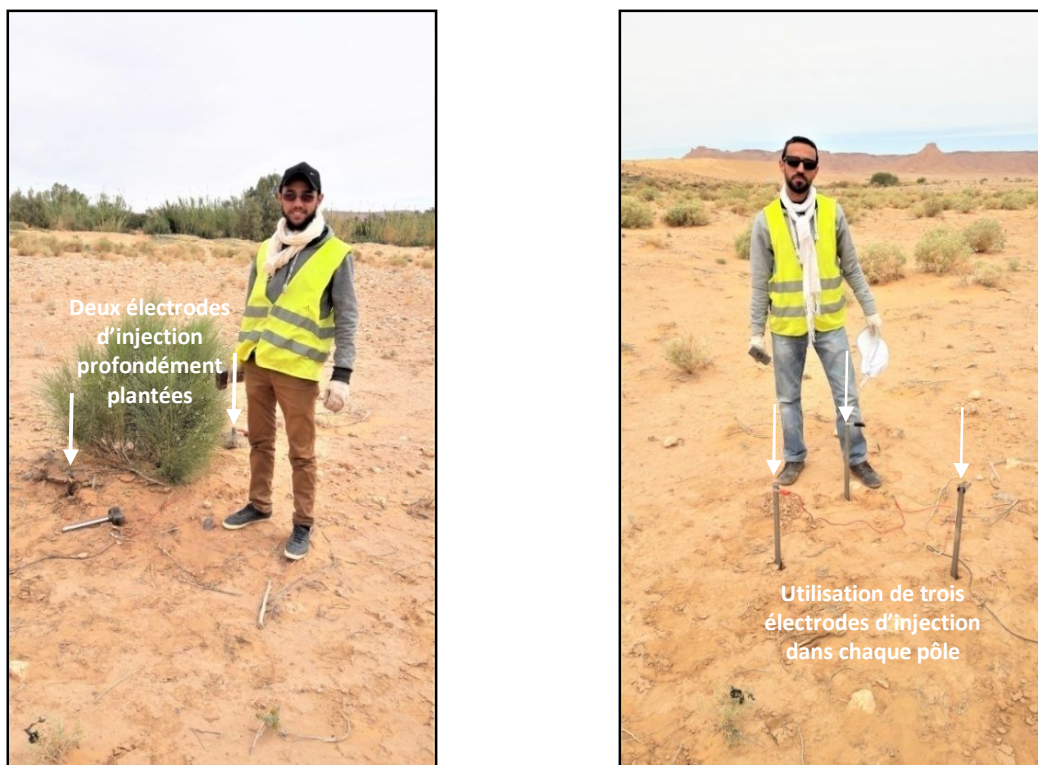
Figure 49 : Envoi du courant lors de l'acquisition des données de résistivité
