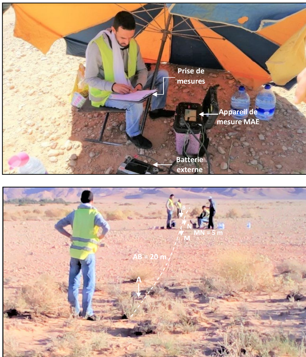
Figure 48 : Equipement de mesure de résistivité apparente du sous-sol utilisé dans la région d'étude Mise en œuvre d'un sondage électrique vertical type Schlumberger
