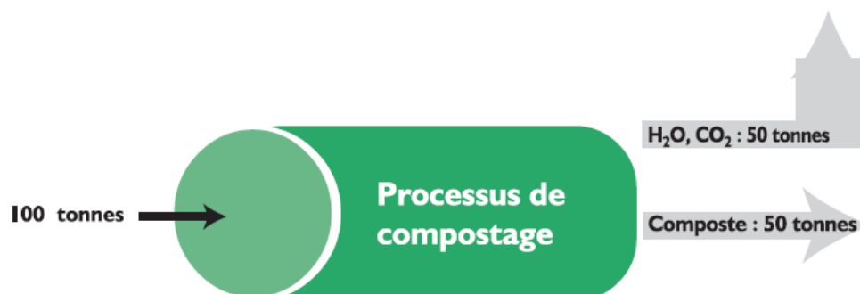
FIGURE 2.5: Bilan matière du processus du compostage (Soudi and Chrifi, 2008).
