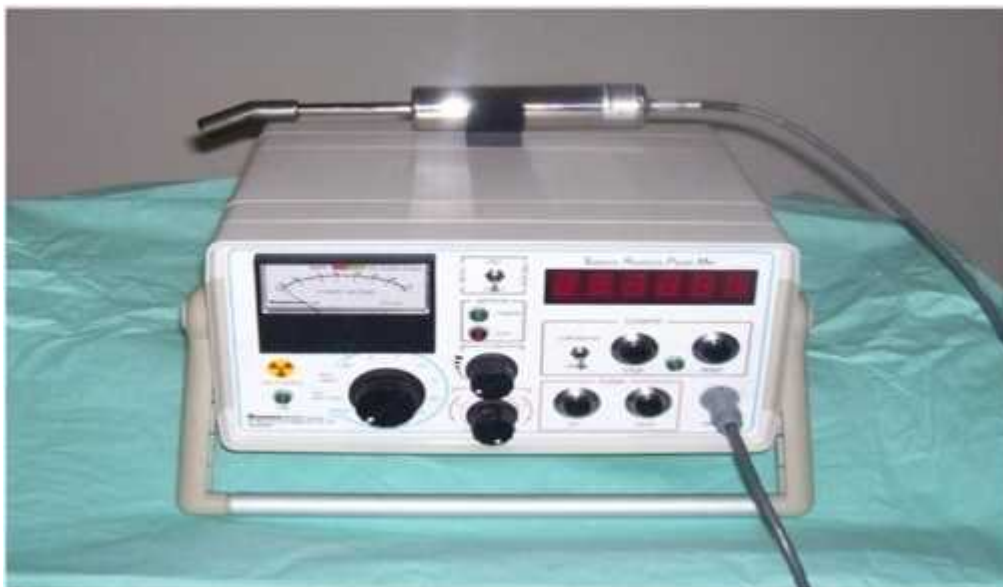
Figure 11 : Sonde de détection isotopique. Gamma probe counter(11)
