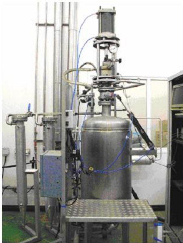
Figure 18 : Photo du réacteur de traitement DIC : on distingue les parties principales qui le composent. A droite l'ordinateur équipé de cartes électroniques permettant l'acquisition des données. (63)
