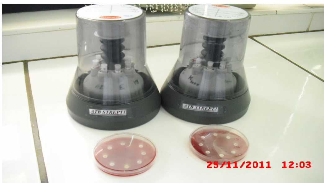
Figure 13 : Distributeurs de disques imprégnés d'antibiotiques et Milieux gélosés coulés en boîtes de pétri, prêts à l'incubation. (Photo prise au laboratoire de microbiologie de l'Hôpital militaire d'instruction Mohammed V, Marguerite Udahemuka . 2011)
