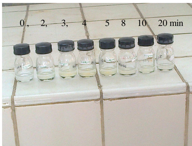
Figure IV.17 : Evolution de la coloration des solutions de la ciprofloxacine au cours de sa photodégradation en présence de 40TiHAp.
