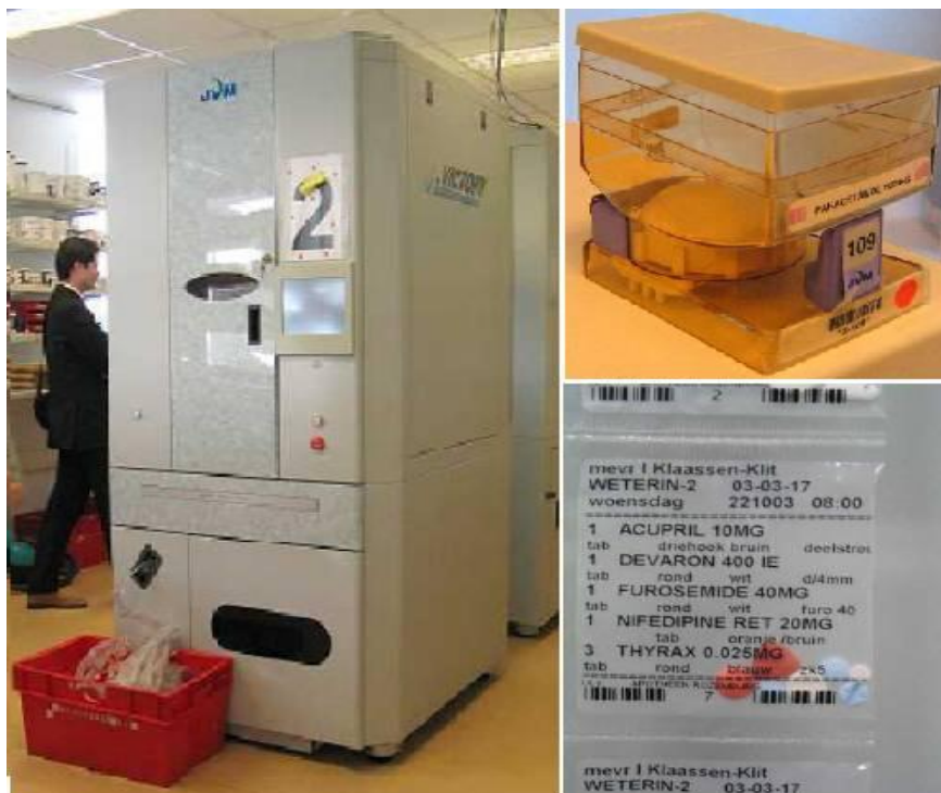
Image 2 : Automate de dispensation de formes orales sèches.
