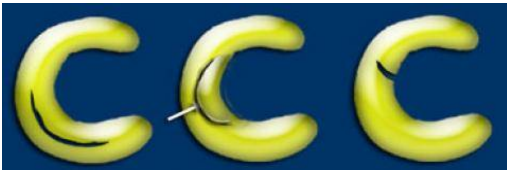
Figure 7: les fissures basiques : Longitudinales, Horizontale et Radiale
