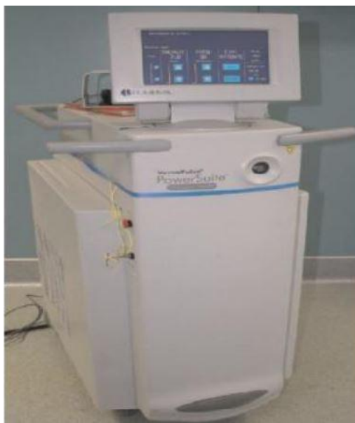
Figure 89 : Générateur laser Holmium Luménis®100 watts.
