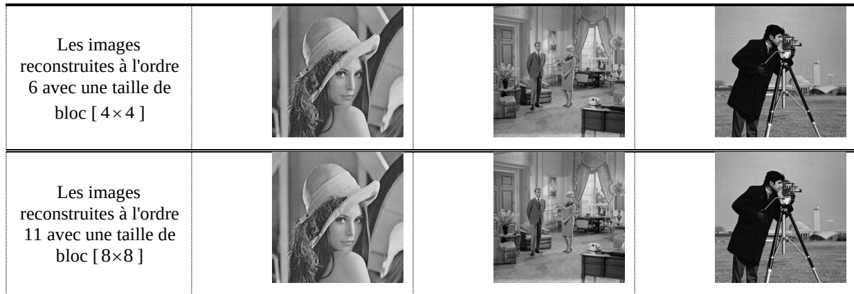
Figure III.17. Images en niveaux de gris reconstruites selon l'approche proposée en utilisant les moments de Charlier calculés à partir des blocs de taille [4x4] et [8x8]
