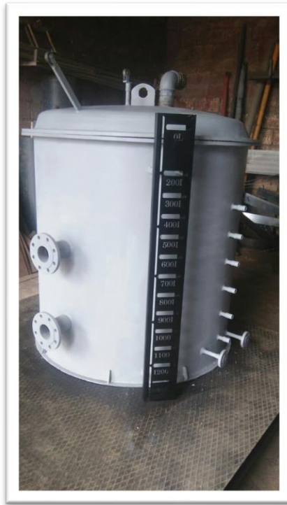
Figure IV-1 : Réservoir du bitume
