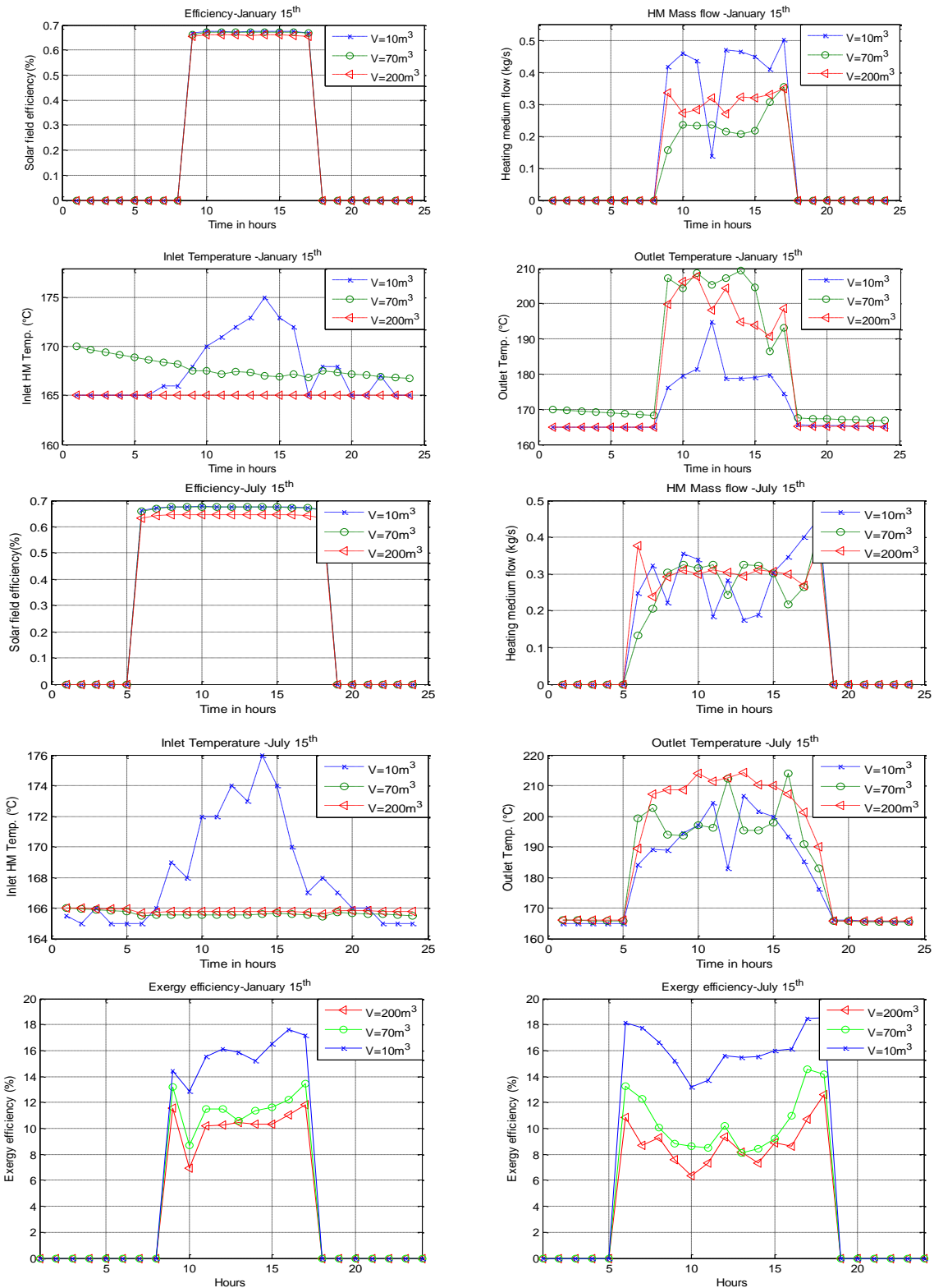
Figure III-11 : Résultats obtenus pour la fonction à double objectif 3-Performances du champ solaire : efficacité, débit massique du fluide caloporteur, température d'entrée et température de sortie - Résultats d'hiver et d'été en tenant compte des différentes capacités de stockage thermique- Besoin énergétique : 7kW
