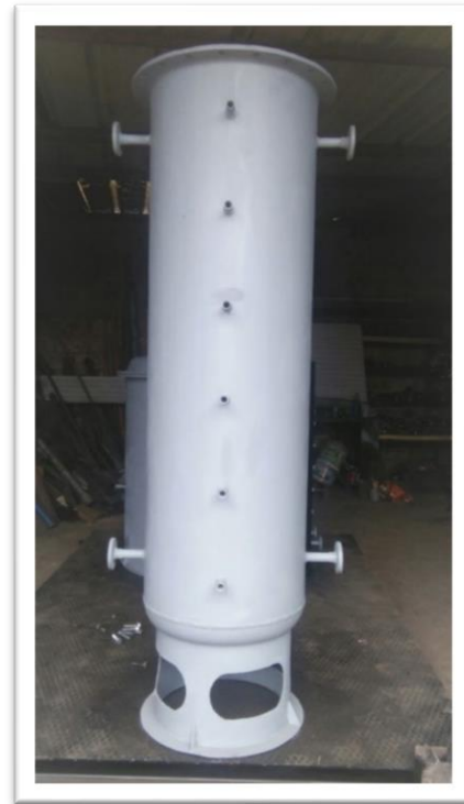
Figure IV-2: Réservoir de stockage de l'huile thermique
