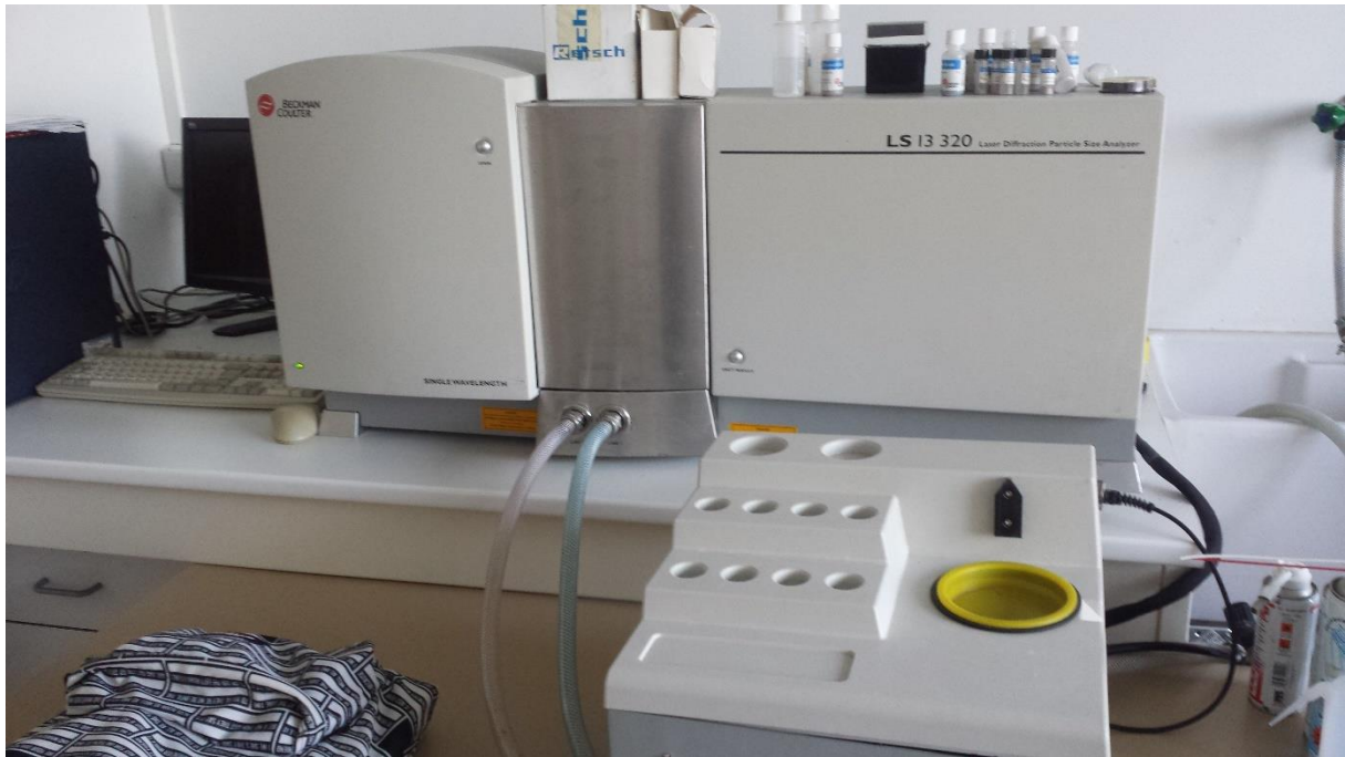
Figure 12 : Granulomètre Beckman Coulter LS 130 à diffraction laser du laboratoire des Géosciences de l'Université de Montpellier, utilisé pour analyser les particules sédimentaires dans la gamme allant jusqu'à 2000 \mu\text{m} . Les classes granulométriques utilisées sont : Argile < 2 \mu\text{m} Limons fins 2 \mu\text{m} à 20 \mu\text{m} , Limons grossiers 20 \mu\text{m} à 50 \mu\text{m} , Sables fins 50 \mu\text{m} à 200 \mu\text{m} , Sables grossiers 200 \mu\text{m} à 2 000 \mu\text{m} .
