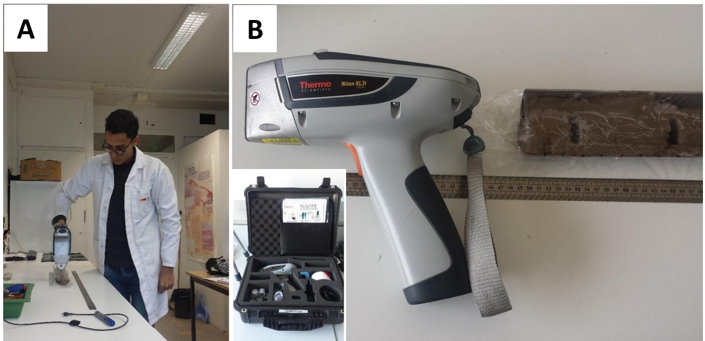
Figure 14 : A : Laboratoire de Géosciences à l'Université de Montpellier. Les mesures XRF ont été effectuées tous les 2 cm avec un temps de comptage de 120s et une intensité d'accélération de 50 kV. L'appareil émet un rayonnement de fluorescence X capté par un détecteur XRF placé à 45° par rapport à la surface du sédiment. B : Générateur à fluorescence-X mobile Niton XL3t GOLDD+
