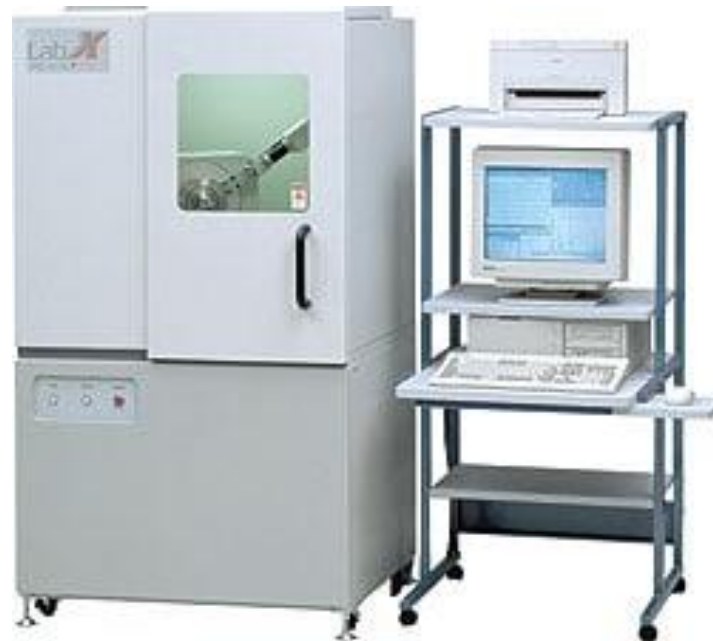
Figure 13 : Diffractomètre XRD-6100 Shimadzu de la Faculté des Sciences de Rabat, utilisé pour caractériser les matériaux des sédiments obtenus, l'analyse a été réalisée sur les poudres obtenues par broyage des échantillons de la carotte TAM01
