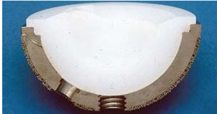
Figure 10 : Coupe transversale d'une cupule non cimentée de 2 ème génération avec une meilleure congruence entre l'insert et la cupule en regard du rebord en polyéthylène [11]
