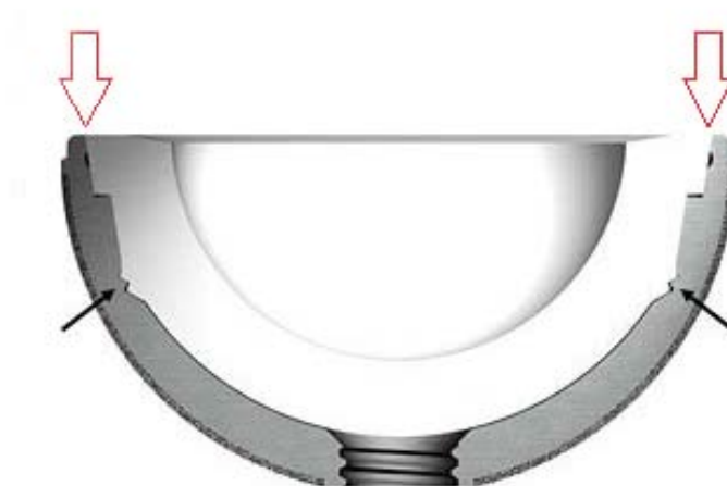
Figure 11 : Coupe transversale d'une cupule non cimentée de 3 ème génération, l'insert en polyéthylène ne dépasse pas la cupule (flèches rouges). Le mécanisme de verrouillage (flèches noires) est encastré à l'intérieur de la cupule pour minimiser les contraintes au niveau de l'insert et éviter la rupture de son rebord en cas d'un impact important.[11]
