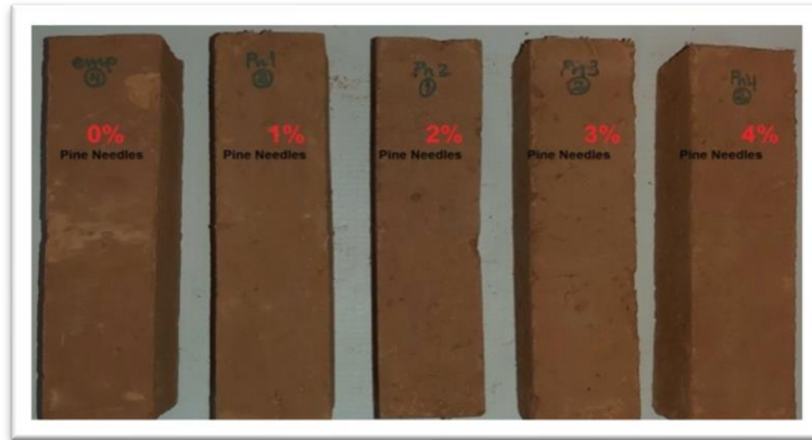
Figure 3. 19: Éprouvettes en terre avec des fibres d'aiguilles de pin.
