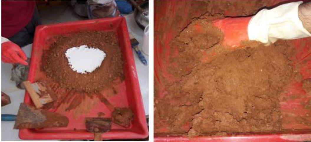
Figure 3. 15: Mélange avec la chaux.
