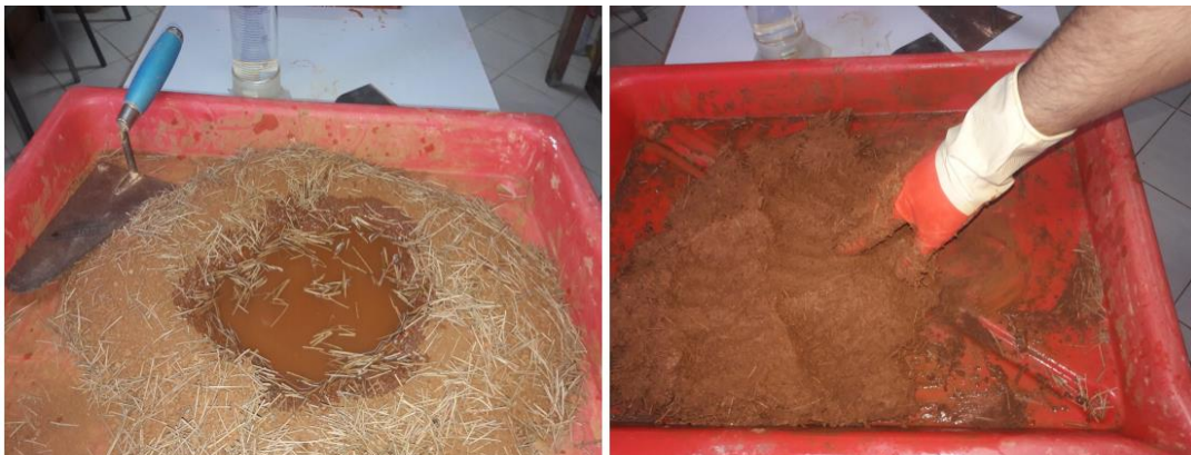
Figure 3. 17: Mélange avec les fibres d'aiguilles de pin.
