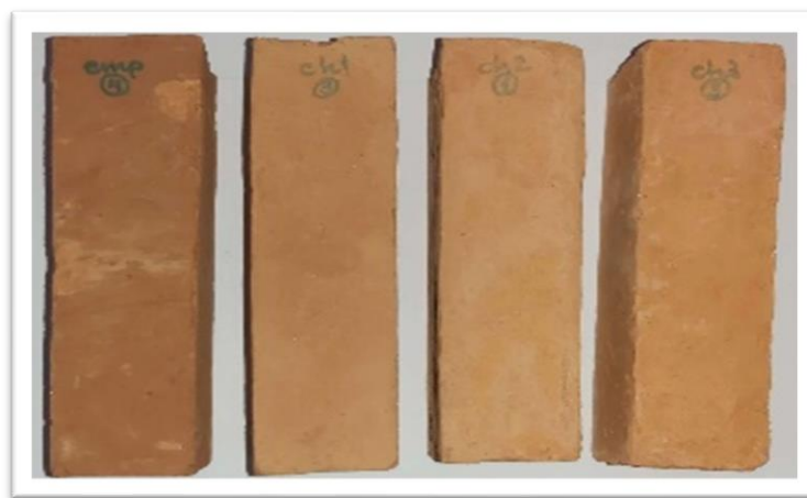
Figure 3. 20: Éprouvettes en terre avec de la chaux.
