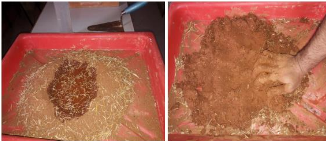
Figure 3. 16: Mélange avec les fibres paille.
