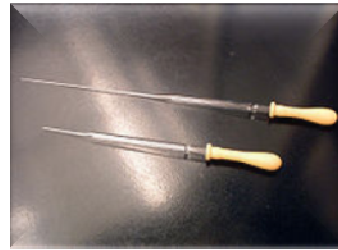
Figure 19 : Pipettes pasteur avec un embout permettant de pomper le liquide [51]
