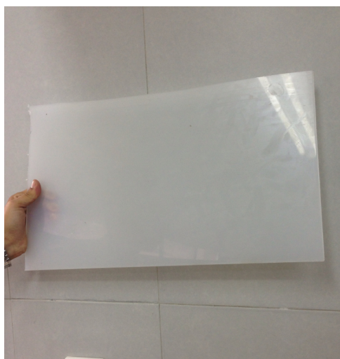
Figure 32 : plaque thermoplastique de polypropylène (Atelier orthopédique HER)
