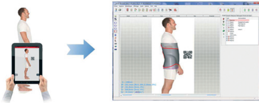
Figure 28 : Techniques d'acquisition tridimensionnelle du tronc à l'aide de la technique de scanner « laser » permettant une acquisition progressive de l'enveloppe corporelle en trois dimensions. Des techniques récentes utilisant une capture vidéo à l'aide de l'iPad permettent d'avoir une acquisition encore plus rapide avec une précision identique. (59)
