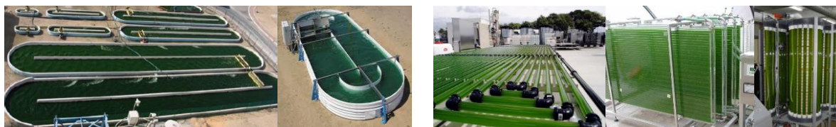
Figure 2 : Systèmes de la culture des microalgues.
