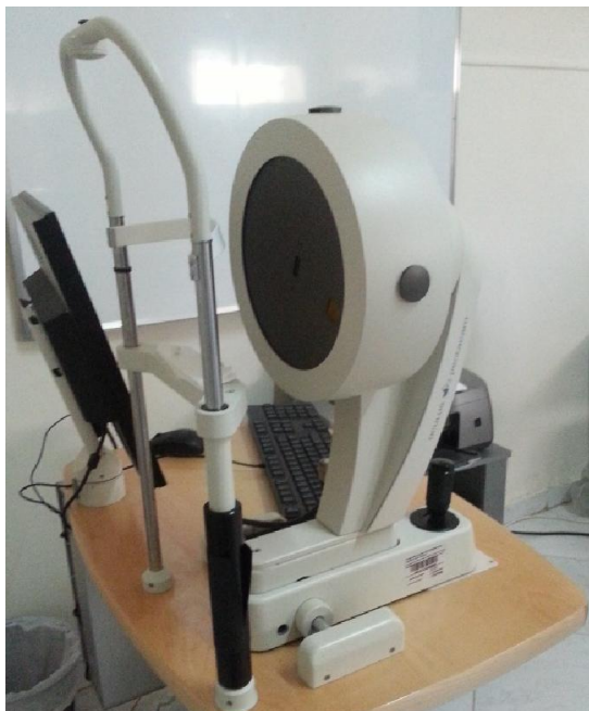
Figure 33: Topographe cornéen de type Pentacam de chez oculus (image du service d'ophtalmologie CHU HASSAN II – Fès)
