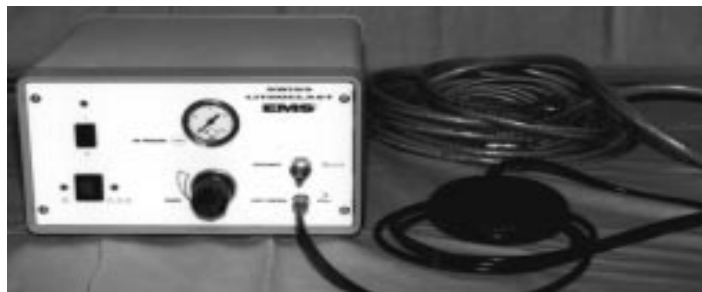
Figure 22: Générateur d'un lithotripteur à percussion mécanique fonctionnant à l'air comprimé.
