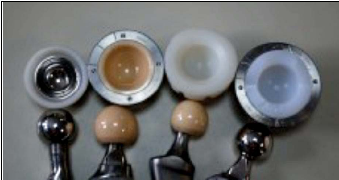
Figure 42: Les différents couples de frottements.
