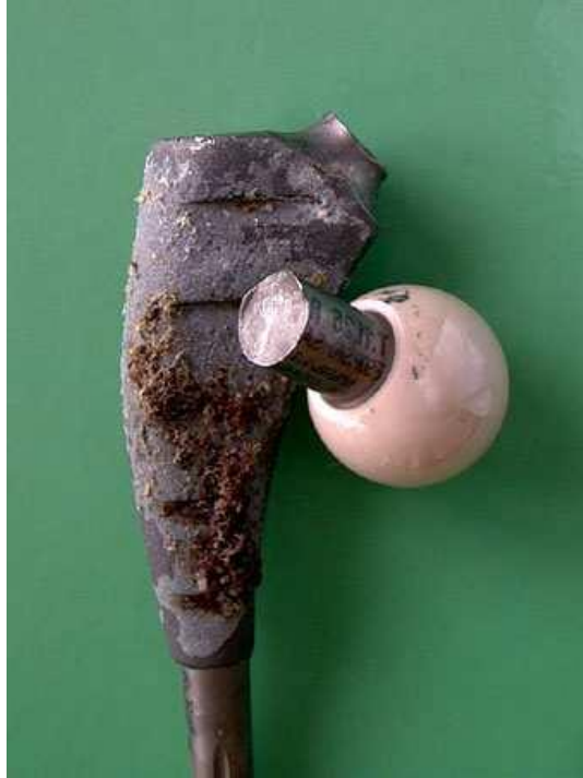
Figure 36 : Fracture du col
