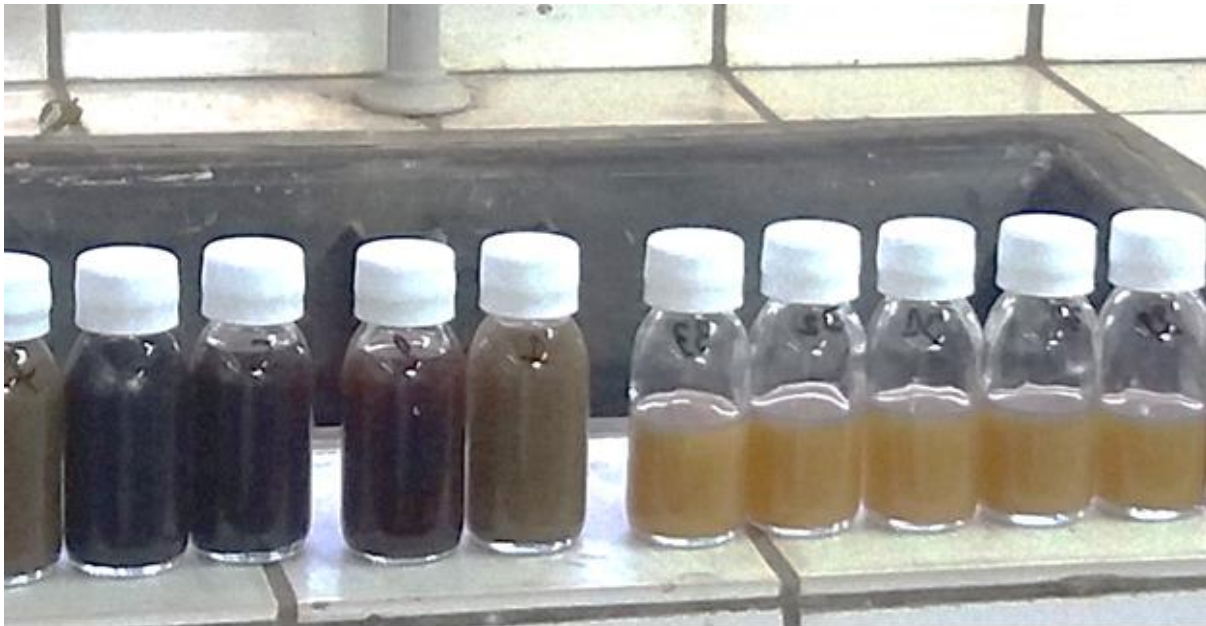
Figure 64: Image rapportant la couleur du lixiviat avant et après coagulation.
