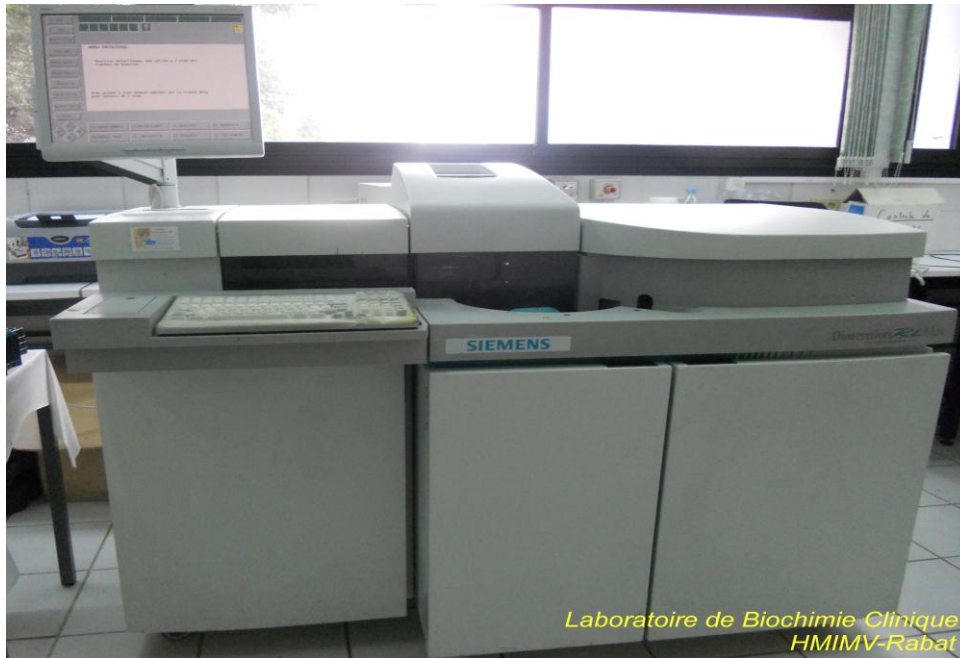
Figure 11 : L'auto-analyseur utilisé dans le dosage des paramètres du bilan lipidique, l'HbA 1c et la créatinine
