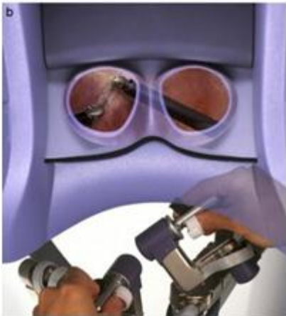
b : les deux caméras tri-ccd fournissent une réelle vision en 3D ; les mains sont dans l'axe du regard, donnant l'impression au chirurgien de les plonger dans le champ opératoire.
