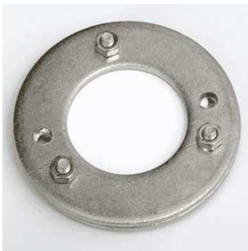
Figure 33 : Dispositif POCIS d'après EST-LAB
