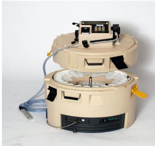
Figure 8 : Préleveur automatique (SIGMA 900) utilisé
