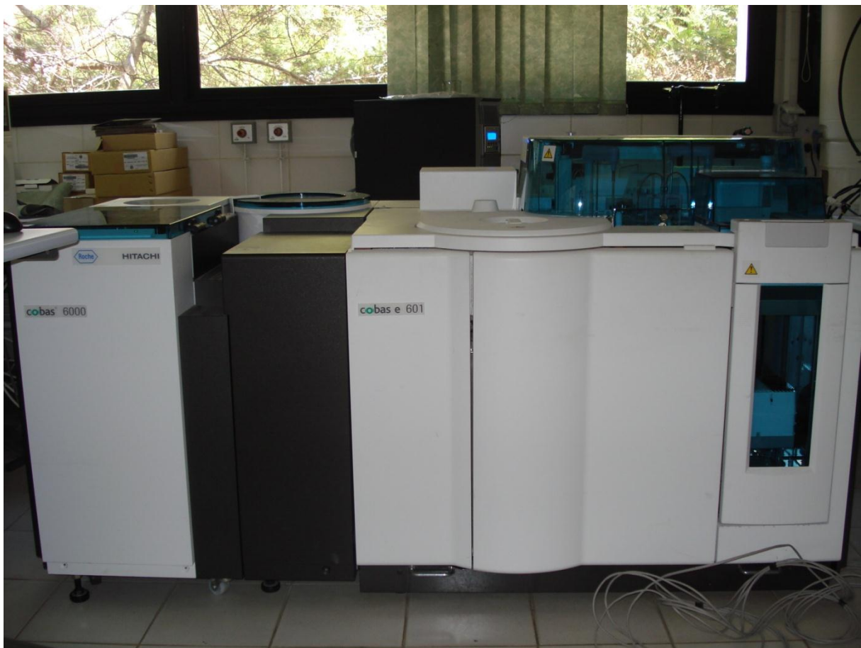
Figure 2: Auto-analyseur Cobas e 601 de la société Roche diagnostic (Laboratoire de biochimie et de toxicologie, HMIMV)
