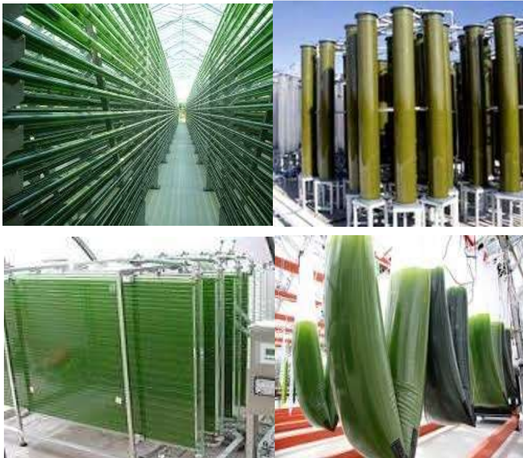
Figure 3 : Photobioréacteurs de différents types (tubulaire, cylindriques, panels, sachets). http://www.bioazul.com/fr/portfolio/algatec-ii/ . http://algue-production-energie.e-monsite.com
