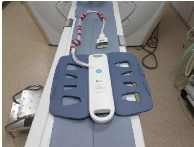
Figure 33: Antenne externe en réseau phasé. Service de radiologie Hôpital Militaire Moulay Ismail de Meknès.
