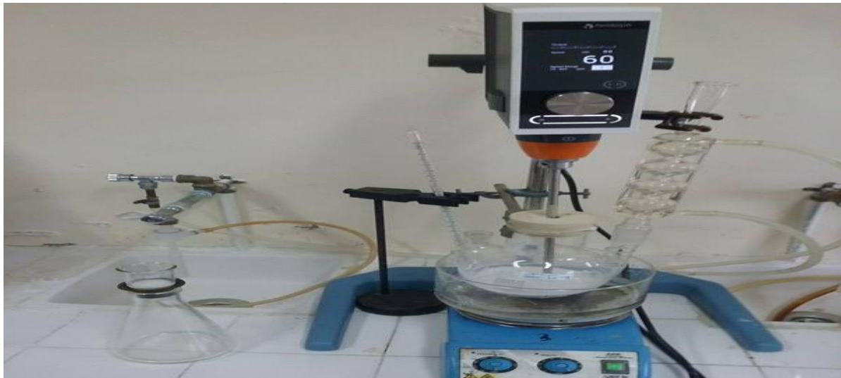
Figure 2 : Procédé dihydrate de préparation de phosphogypse
