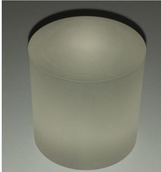
Figure II-8: Photo représente un segment du filtre de Saphir
