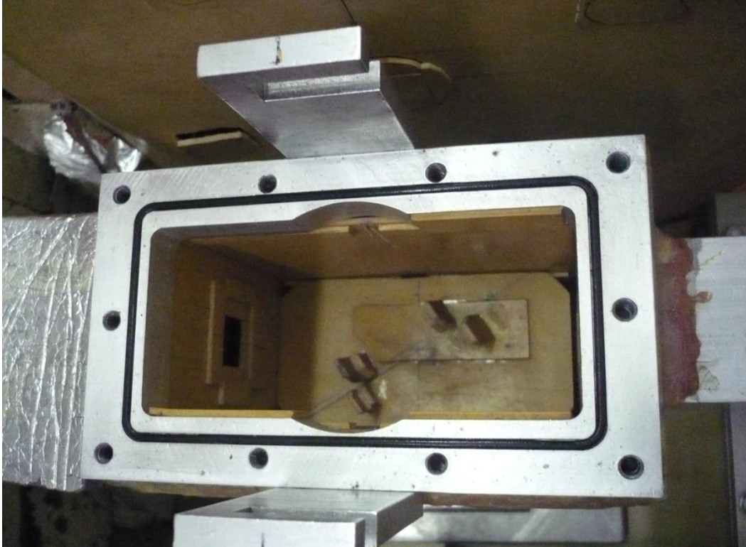
Figure II-40 : Photo de chambre d'irradiation à l'intérieur converti par feuil de LiF blinder par Al
