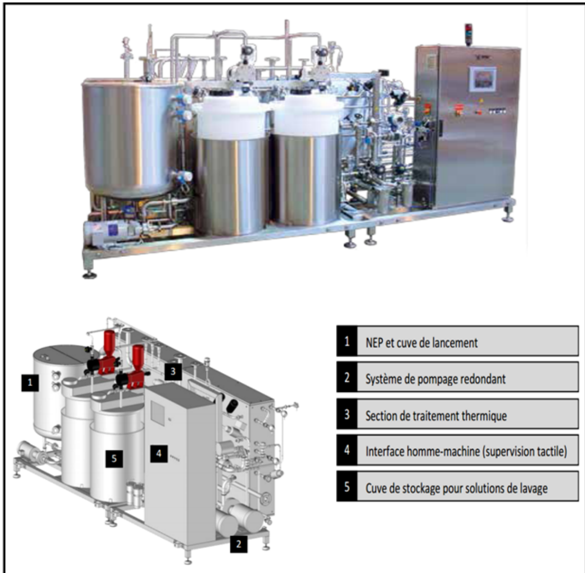
Figure 15 : Décontamineur thermique en continu.
