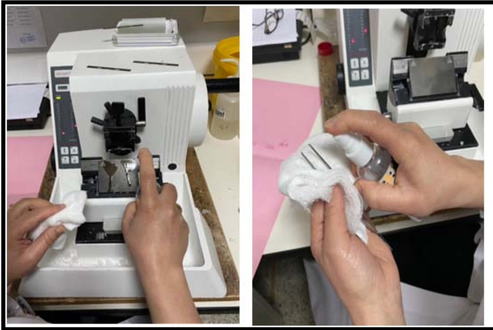
Figure 2 : Essuyage du microtome et de la pince par DNA lytique, service d'anatomie pathologique CHU Mohammed VI Marrakech
