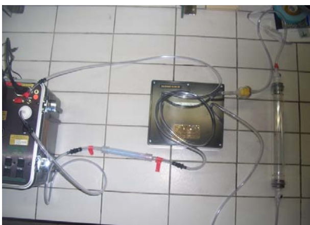
Photo 12 : Calibrage du RAD7 à l'aide d'un background < 0.3 dpm/L
