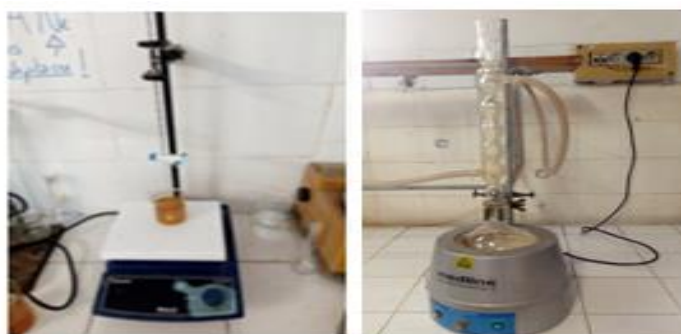
Figure 107: Dispositif de dosage pour déterminer l'indice d'ester I_e et montage à reflux.
