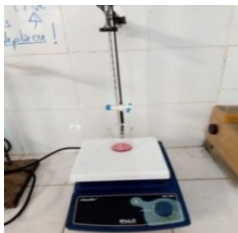
Figure 106: Dispositif de dosage pour déterminer l'indice d'acide I_a
