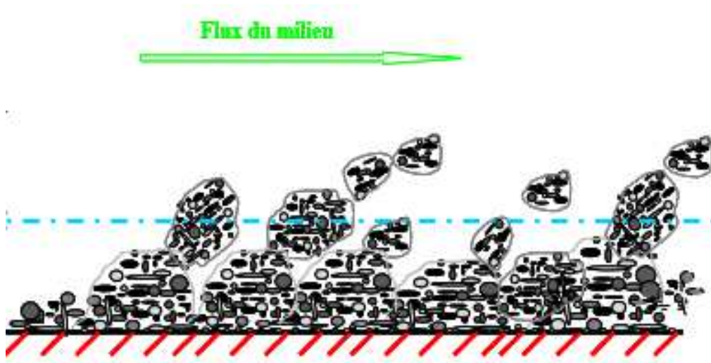
Figure 6 : Détachement superficiel du biofilm [140]
