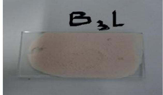
Figure 42 : Photos de suspensions séchées de A 3 et de B 3 sur lame mince, avec A 3 L : liant de A 3 et B 3 L : liant de B 3 .
