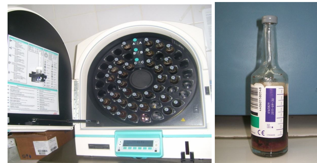
Figure 1 : Bactec 9050® et Flacon Mycosis ICF® (Photo du laboratoire de Parasitologie, HMIM V)
