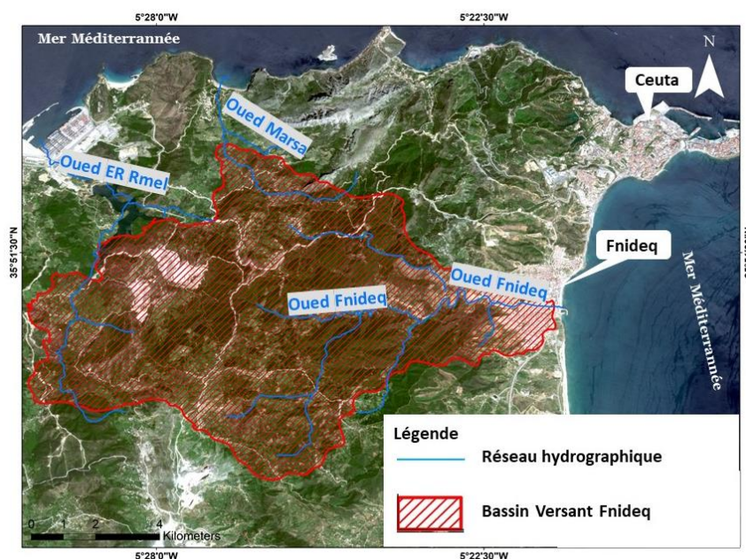
Figure 24: Réseau hydrographique du bassin versant de l'oued Fnideq
