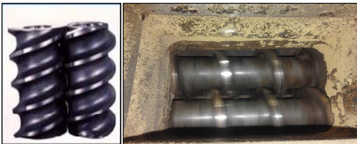
Figure 18 : Forme de deux vis de l'extrudeuse
