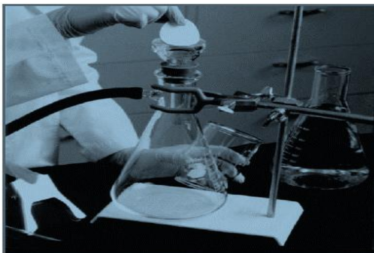
Figure II. 16: Disque pour l'extraction sur phase solide et son dispositif [187]
