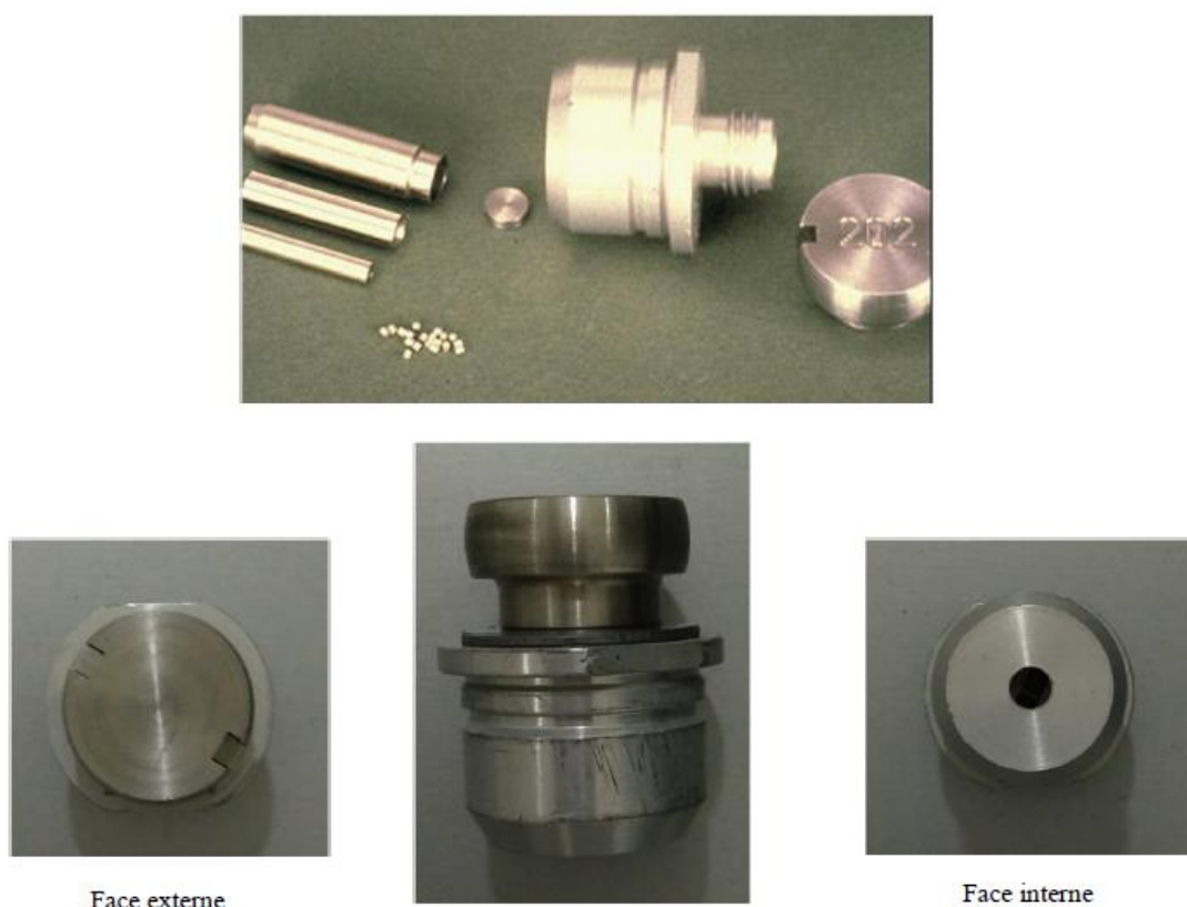
Figure 52 : Photographie des sources de cobalt et des capsules les contenant [178]
