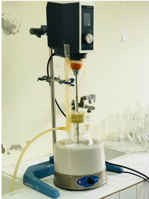
Figure II.2 : Montage de préparation du phosphogypse
