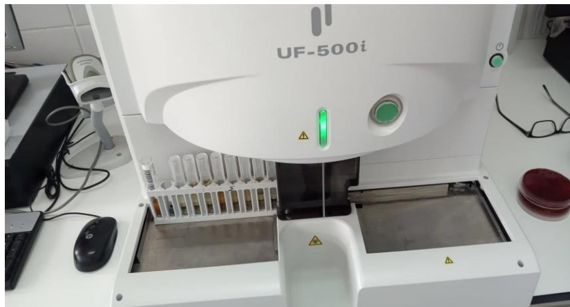
Figure 1: L'automate UF-500i sysmex Europe GmbH utilisé pour l'analyse cytologique des urines.
