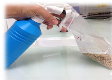
Figure 53 : Imprégnation du catalyseur chimique par aspersion
