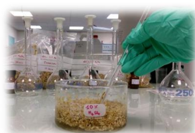
Figure 54 : Imprégnation du catalyseur par immersion
