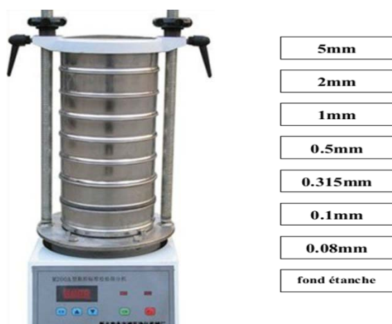
Figure 26 : Dimension des trous des tamis
