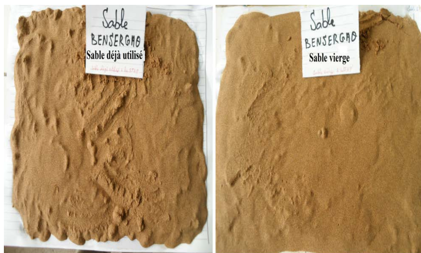
Figure 2 : Les deux types de sable de BENSERGAO qui sont utilisés comme massif filtrant.
