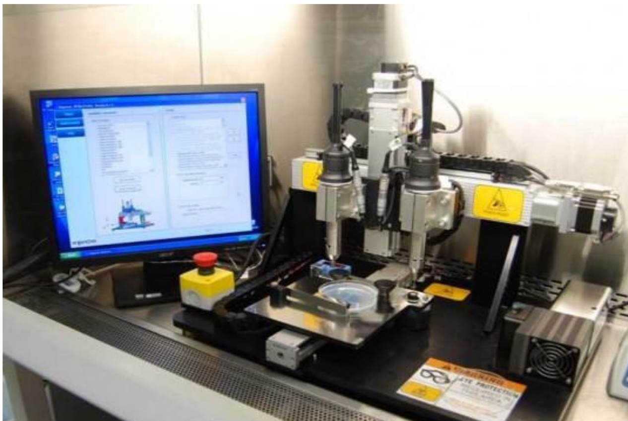
Figure 11 : L'imprimante Novogen MMX, capable de bio imprimer des cellules et tissus humains ( www.biotechnika.org ). [30]
