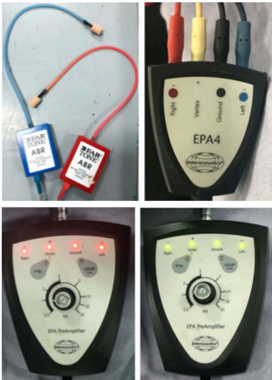
Figure 4. Transducteurs, électrodes et préamplificateur des PEA
