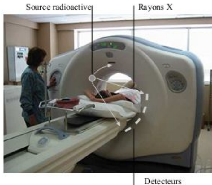
Figure n°11 : Image d'un scanner tomographique spiralé. L'acquisition est continue pendant que la table fait avancer lentement le patient dans le plan d'acquisition
